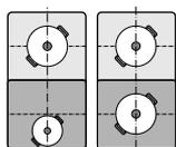
Les zones avant et arrière, qui possèdent deux inducteurs chacune, peuvent être utilisées indépendamment en réglant la puissance nécessaire de chacune ; il est alors recommandé d'utiliser uniquement un récipient par zone.
