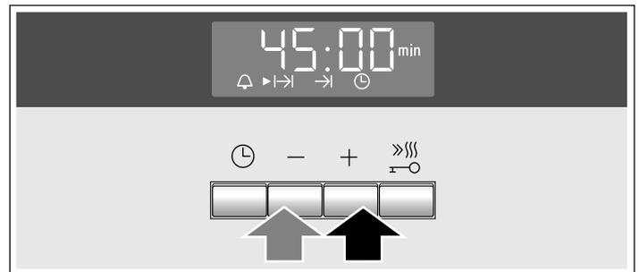
Le four se met en marche quelques secondes plus tard. Dans l'affichage, la durée s'écoule visiblement et le symbole
